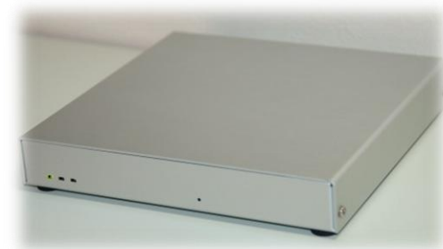
おそらく世界最小のBGPルータ 11.8 × 11.5 × 2.8 (cm) 実験的に社内で作成
