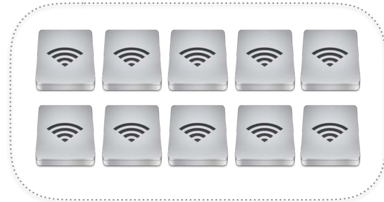
AP (コントローラがないと動かない)
