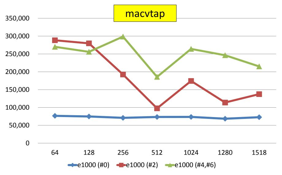
vCPU Num/Pinning による性能差(fps)ホスト割込みCoreとVMのCoreが同じ場合、Core性能がボトルネックに
